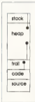
Figura 7 - La mappa di memoria in Turbo Prolog. (da Dan Chaffin, con l'aiuto)
